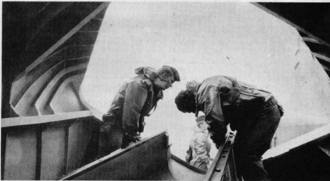
Die Hangargasten des RS-Bootes AUGUST LUTGENS bereiten sehr gewissenhaft die Startrampe für die Übernahme der Rakete vor und überprüfen den technischen Einsatzklarzustand.
